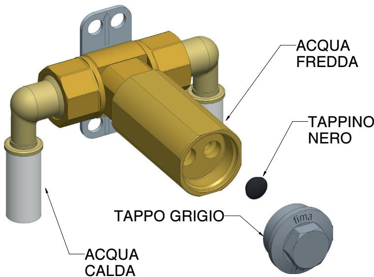
**PASSO #2 :** Dopo aver collegato gli ingressi di acqua calda e fredda occorre provvedere al flussaggio delle tubazioni per renderle perfettamente prive di residui. Perciò rimuovere il tappo grigio ed aprire per breve tempo sia l'acqua calda che la fredda. Poi rimontare il tappo grigio.
