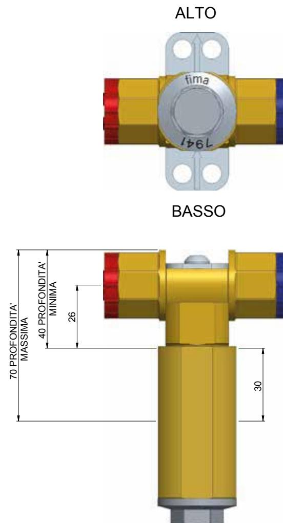
PASSO #1 : Installare il corpo da incasso rispettando le indicazioni dell'etichetta riguardanti la profondità MIN e MAX dell'installazione. Prestare attenzione al corretto orientamento del corpo stesso (frecce sulla piastrina inox rivolte verso l'alto) ed utilizzare una livella per regolare il posizionamento orizzontale. Vedi figura sopra.
