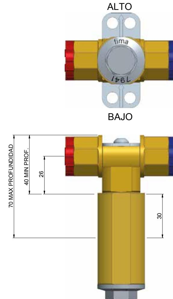
PASO#1: Instalar el cuerpo empotrado respetando las indicaciones acerca de la profundidad máxima y mínima. Prestar atención de la correcta orientación del cuerpo empotrado (flecha indicando la parte alta) y usar un nivel para ajustar la posición horizontal correcta. Ver figuras adjuntas.
