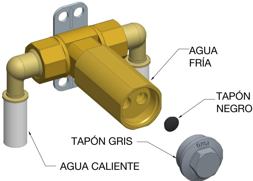
**PASO #2:** Una vez realizadas las conexiones de agua caliente y fría, hay que limpiar las cañerías para que estén perfectamente limpias. Para hacer esto, desmontar el tapón gris y abrir brevemente las llaves de paso del agua caliente y fría. Una vez limpias, volver a montar el tapón gris.
