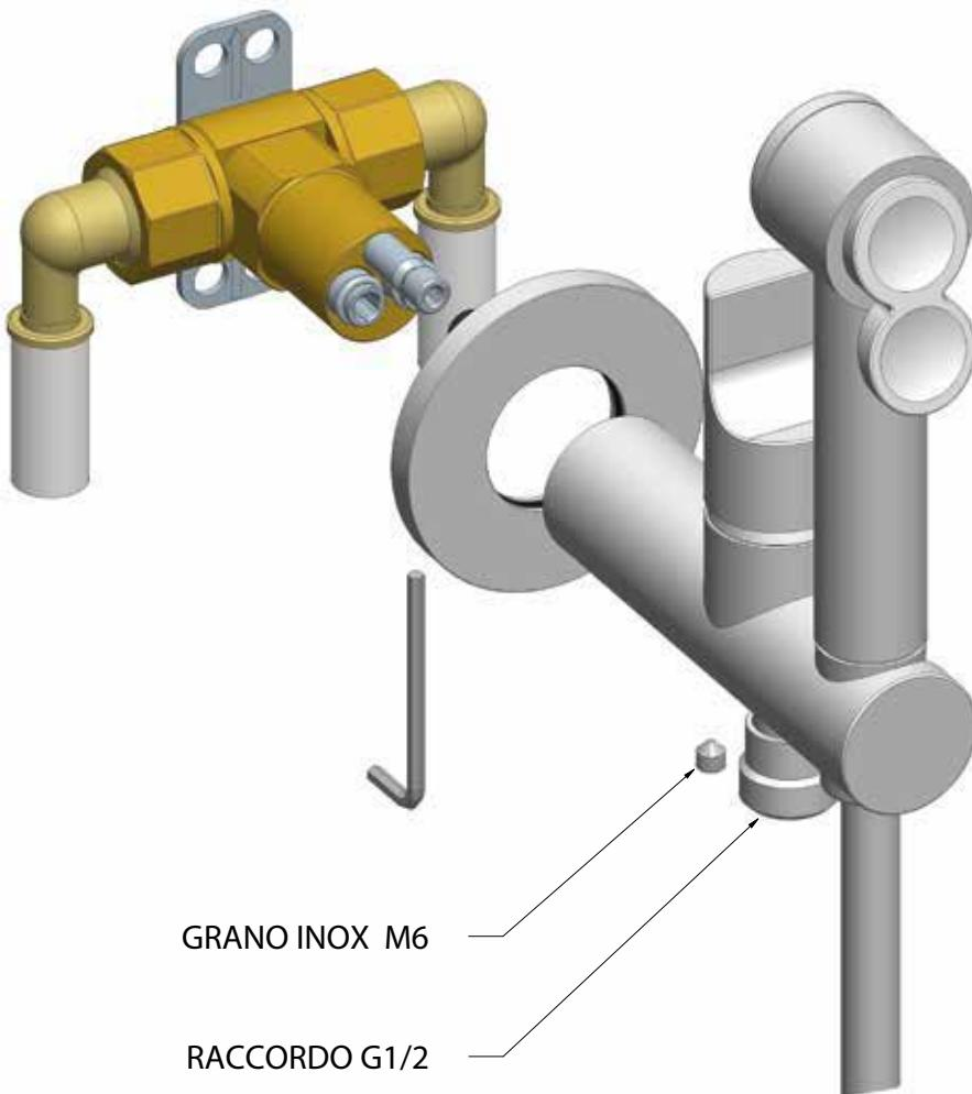
PASSO #5 : Dopo aver rimosso il coperchio, montare il rosone sulla parte esterna cromata ed inserirla nel corpo da incasso, fissandola con il grano inox M6 incluso. Poi collegare il flessibile alla doccetta shut-off ed al raccordo G1/2 presente nella parte inferiore. Vedi figura sopra.
