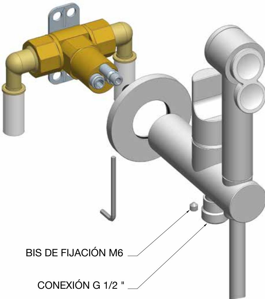
PASO #5: Una vez extraido el tapón, incorporar el embellecedor sobre la parte externa del grifo y montarlo, fijándolo con el bis M6 incluido. Conectar el flexo a la ducha de mano y a la toma G 1/2 " del cuerpo. Ver figura adjunta.
